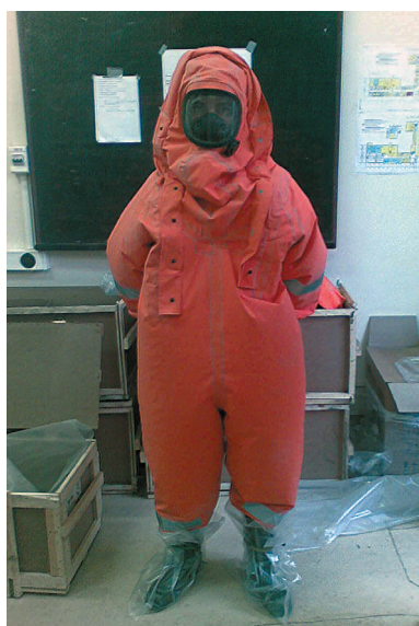
Рис. 3. Средства индивидуальной защиты для работы в помещениях с высоким содержанием радионуклидов в воздухе рабочей зоны
