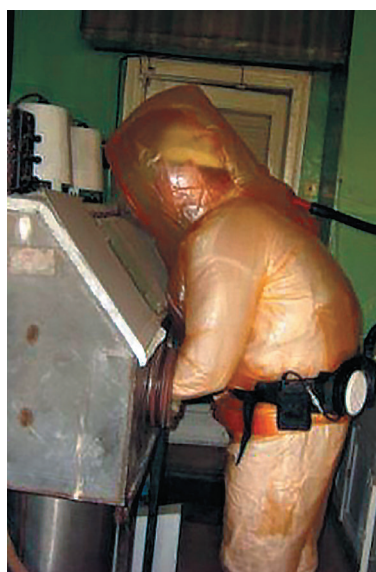
Рис. 3. Средства индивидуальной защиты для работы в помещениях с высоким содержанием радионуклидов в воздухе рабочей зоны
