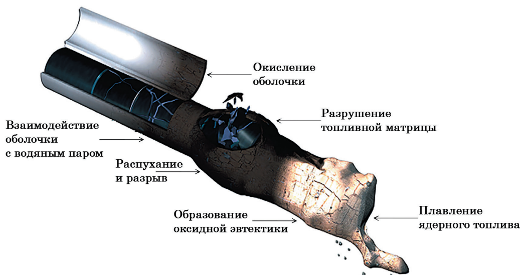
Рис. 1. Разрушение топлива в результате пароциркониевой реакции [Fig. 1. Destruction of fuel due to steam-zirconium reaction]
