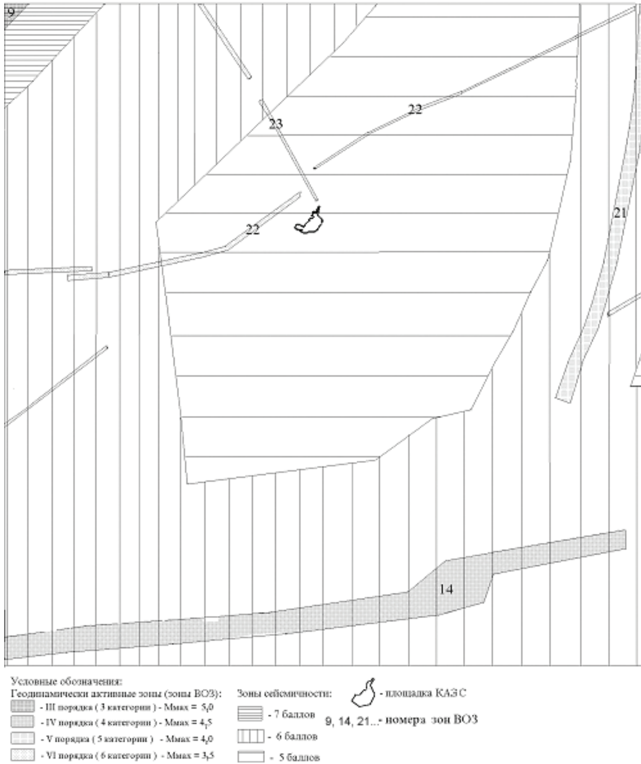
Рис. 4. Результаты уточнения сейсмических условий ближнего района размещения Калининской АЭС. Фрагмент схемы ДСР ближнего района размещения Калининской АЭС. Масштаб 1 : 50 000
