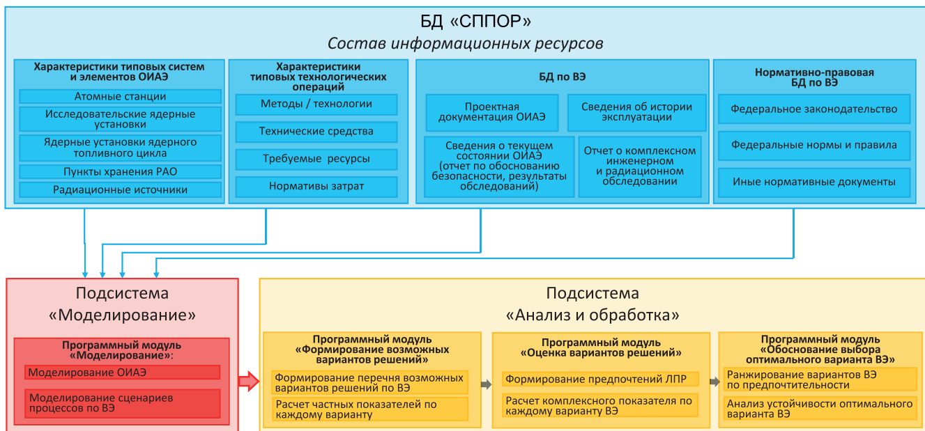
Рис. 1. Функциональная структура «СППОР» по выводу из эксплуатации объектов использования атомной энергии [Fig. 1. Functional structure of “SPPOR” for decommissioning of a nuclear facility]
