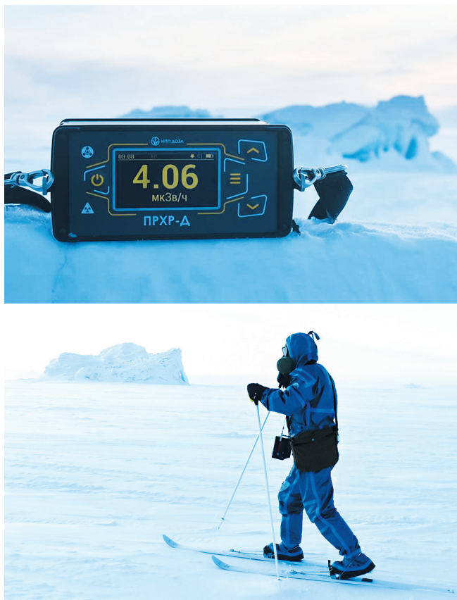
Рис. 4. Опытная эксплуатация прибора радиационно-химической разведки и контроля ПРХР-Д в условиях российского Заполярья [Fig. 4. Experimental operation of the radiation-chemical reconnaissance and control device PRHR-D in the conditions of the Russian Arctic]
