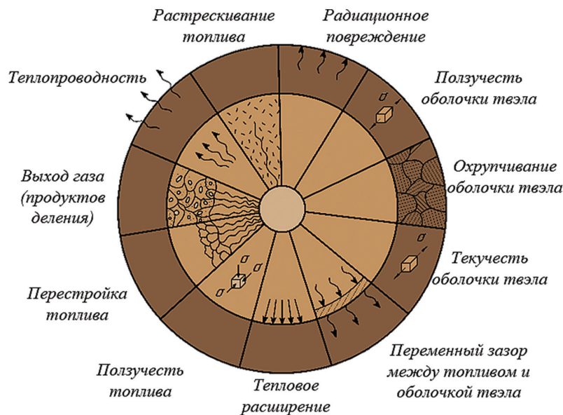
Рис. 1. Факторы, влияющие на работоспособность оболочки твэлов [Fig. 1. Factors affecting the performance of the fuel rod cladding]
