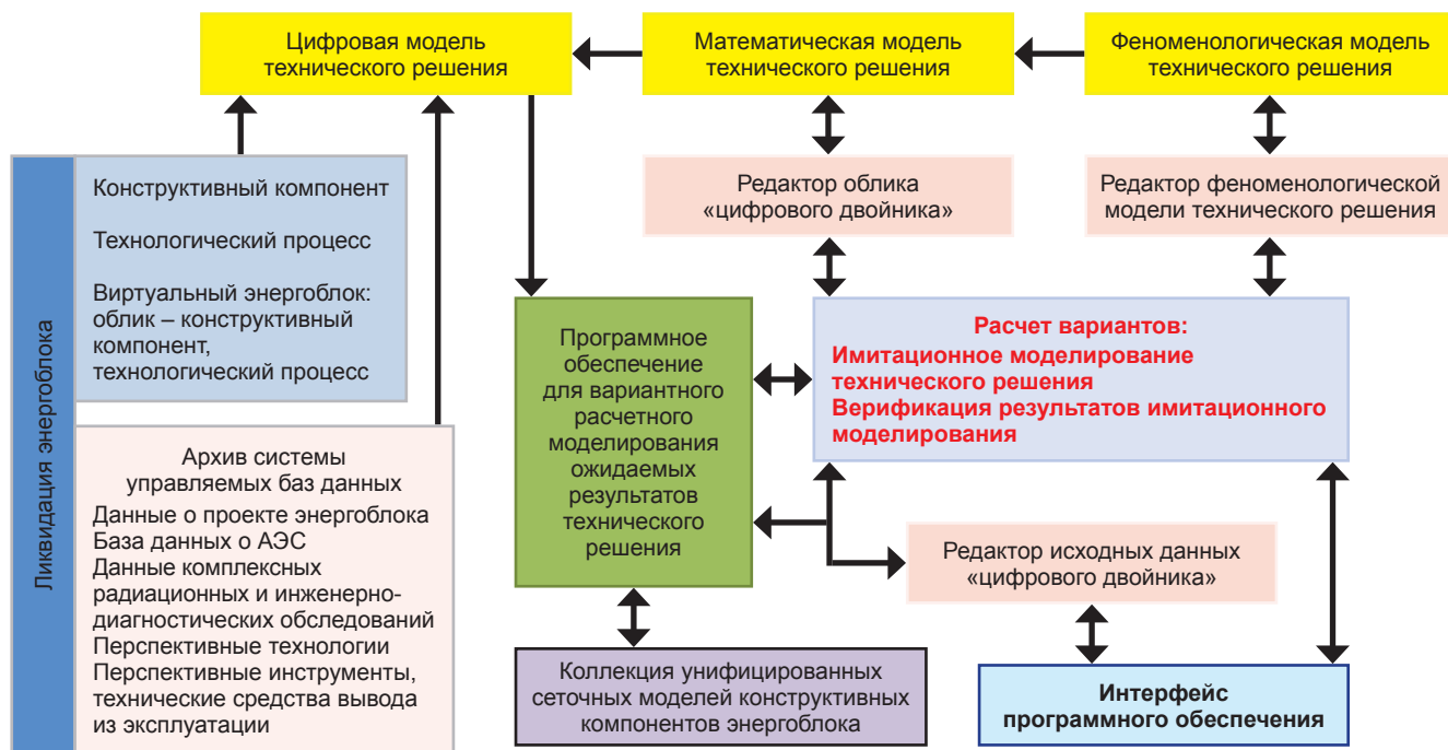
Рис. 3. Архитектура виртуальной среды программного обеспечения «цифрового двойника» технического решения при ликвидации энергоблока АЭС [Fig. 3. Architecture of the virtual environment of the software “digital twin” of the technical solution during the liquidation of the NPP power unit]
