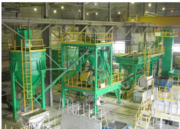
Рис. 5. Технологический модуль по производству контейнеров
