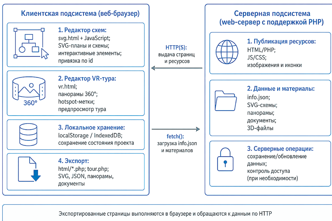
Рис. 3. Архитектура программного комплекса «СмартТур» [Fig. 3. Architecture of the SmartTour software complex]
