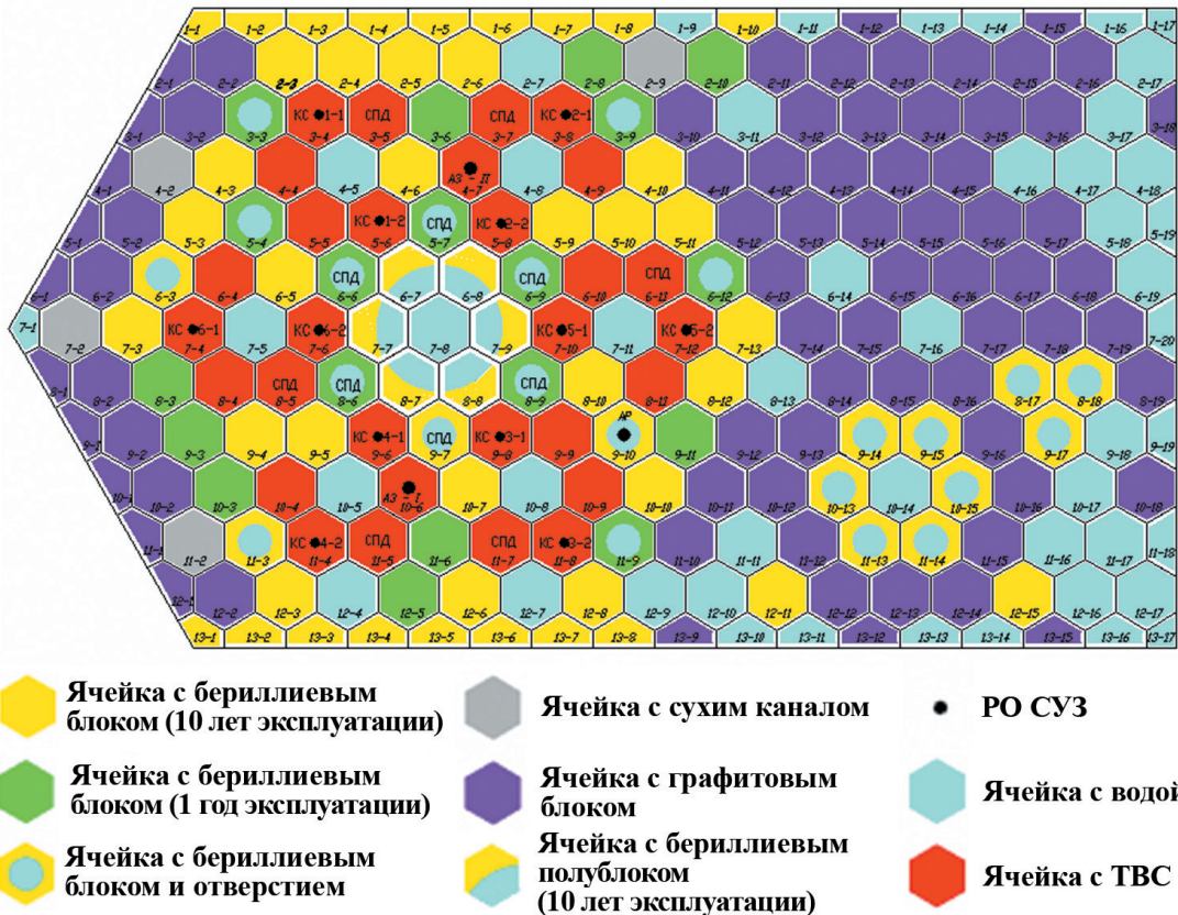
Рис. 10. Картограмма стартовой загрузки активной зоны реактора ИВВ-2М [Fig. 10. Cartogram of the IVV-2M core inventory]
