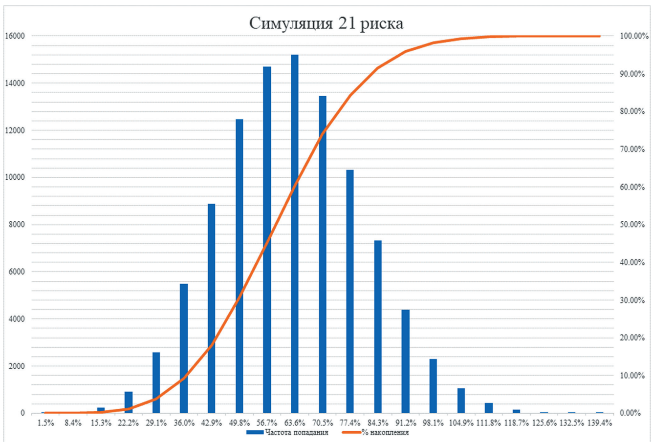
Рис. 4. Диаграмма распределения плотности вероятности отклонения стоимости проекта по выводу из эксплуатации блока АС от базового бюджета проекта с учетом рисков (для 21 фактора риска) [Fig. 4. Diagram of the probability density distribution of the deviation of the nuclear power plant unit decommissioning project cost from the baseline project budget, accounting for risks (for 21 risk factors)]
